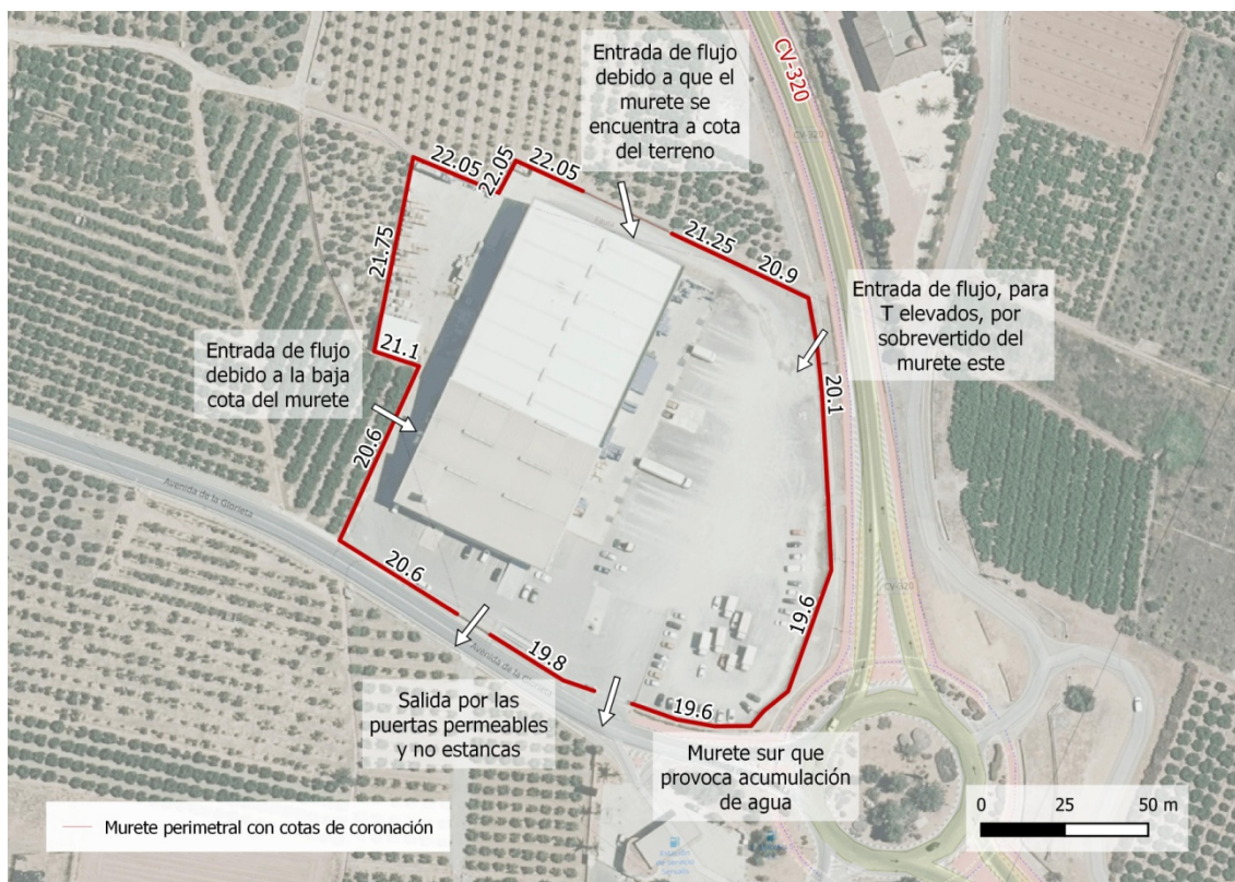
Figura 73: Cotas del murete en situación actual e identificación de los puntos críticos identificados
