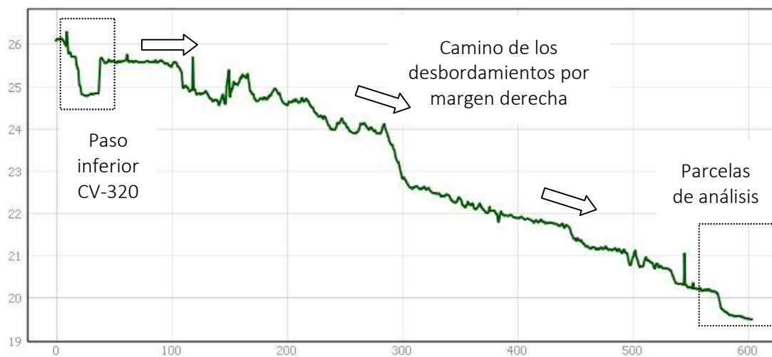
Figura 20: Perfil longitudinal del camino seguido por los desbordamientos por margen derecha del Bco Codoval y que discurren paralelos a la CV-320
