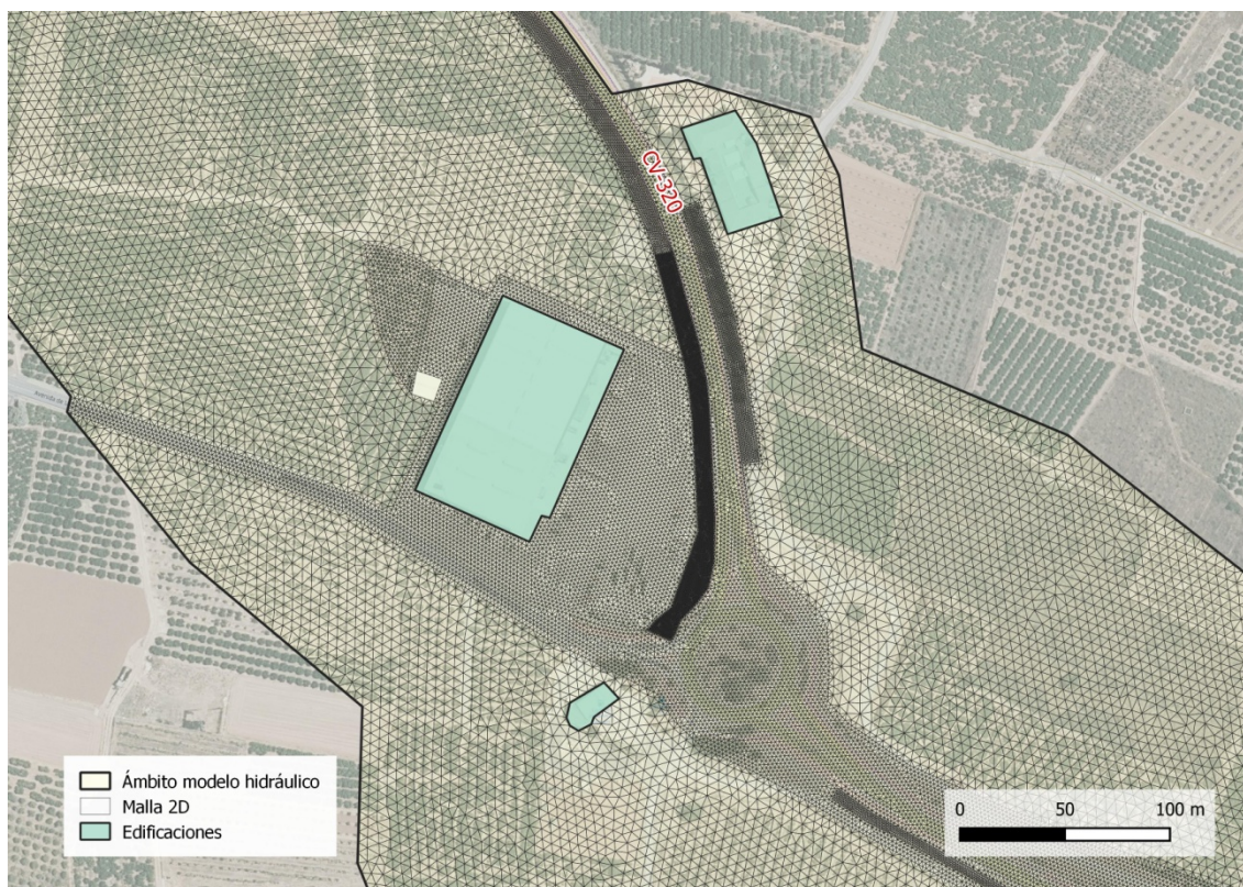
Figura 43: Detalle de la malla 2D empleada en la simulación hidráulica
